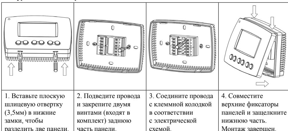
**ПРИМЕЧАНИЕ:** Убедитесь, что провода были подключены в точном соответствии с электрической схемой пульта и не подвергайте их воздействию грязи, воды или других
