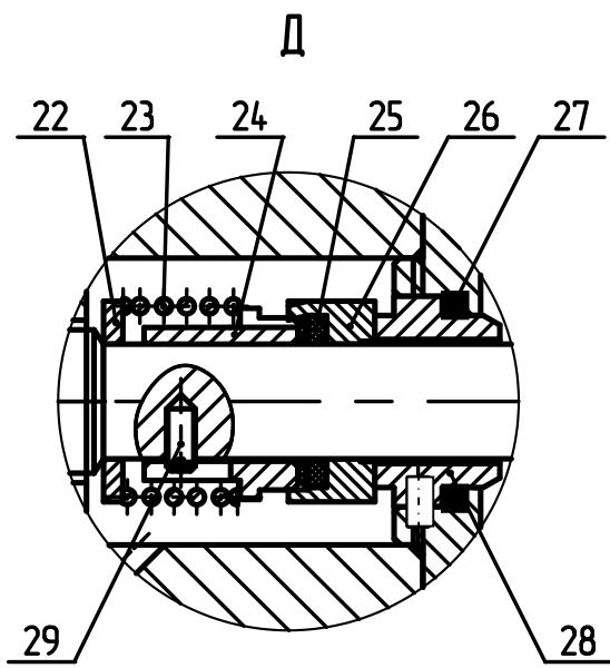
Уплотнение торцовое производства АО «ГМС Ливгидромаш»
