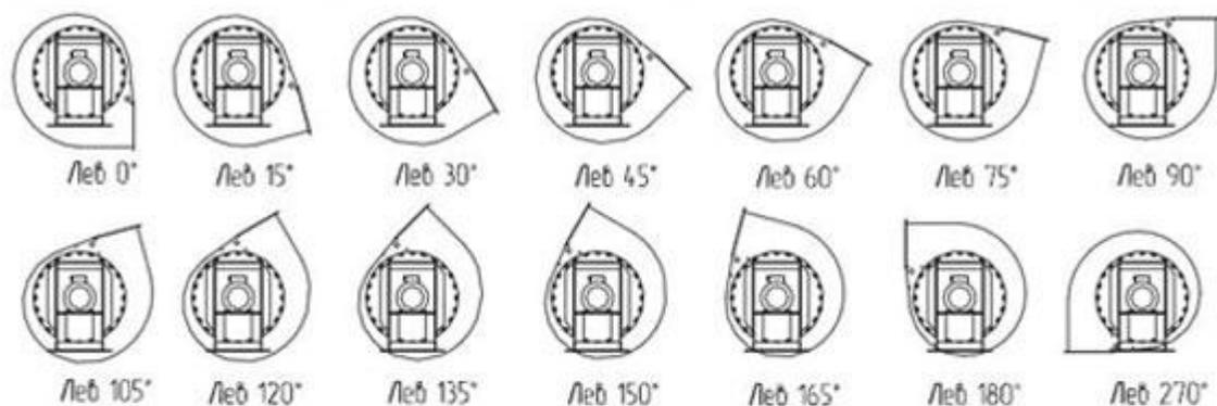
ПОЛОЖЕНИЕ КОРПУСА ТЯГОДУТЬЕВЫХ МАШИН ТИПА ВДН И ДН. (ПР)
