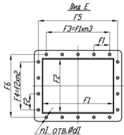
Схема расположения отверстий для крепления вентилятора
