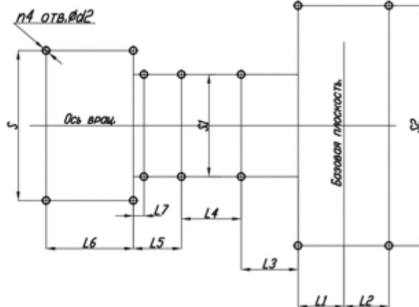
ПОЛОЖЕНИЕ КОРПУСА ТЯГОДУТЬЕВЫХ МАШИН ТИПА ВДН И ДН. (ЛЕВ)
