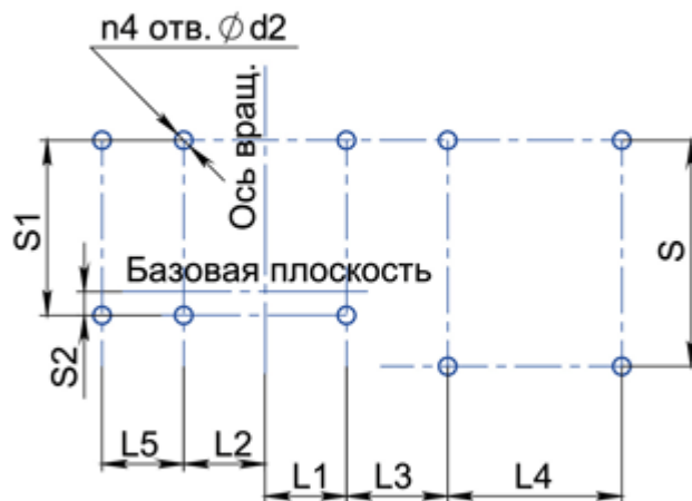
Схема расположения отверстий для крепления вентилятора
