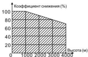
Рисунок 3-5. Снижение номинальной мощности преобразователя частоты EFIP20 в зависимости от высоты над уровнем моря
