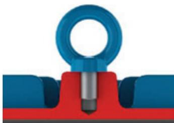
Рисунок 4.1 - Правильное затягивание рым-болта
