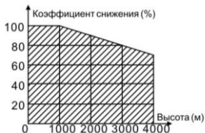
Рисунок 2-3. Снижение номинальной мощности преобразователя частоты EFIP-200A в зависимости от высоты над уровнем моря
